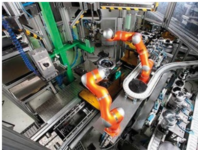
Greifarm eines Leichtbauroboters bei Mercedes-Benz
